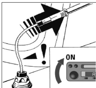
Radio kurz aus- und wieder einschalten. Die Antenne fährt das Teleskop und den gezahnten Kunststoffdraht vollständig aus. Ggf. Vorgang wiederholen. Die Elektronik begrenzt die Laufzeit jeweils auf ca. 12 Sekunden.
