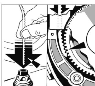
Radio ausschalten - den Kunststoffdraht kurz nachdrücken bis er vom Antrieb erfasst wird. Erfolgt keine Mitnahme, so ist die Zahnung des Kunststoffdrahtes verdreht. Radio nochmals kurz ein- und ausschalten (neue Laufzeit von 12 Sek.). Kunststoffdraht nochmals stochernd und geringfügig verdreht einführen. Rohre nachführen und Gewindegewinde einsetzen und einschrauben.
