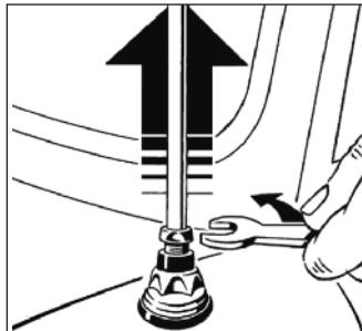
Teleskop so weit wie möglich ausfahren (Radio einschalten). Gewindegewinde lösen - dabei das Teleskop festhalten und auf die Richtung der Zahnung des Kunststoffdrahtes achten.
