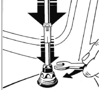
Gewindegewinde festziehen (2 Nm) und Teleskop zur Kontrolle nochmals aus- und einfahren.
